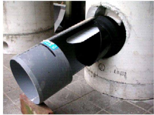
写真-12 設置イメージ(排水時)
