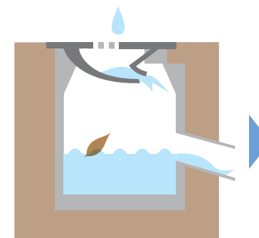
流れ込んだ雨水などの排水や ゴミが底に溜まる
