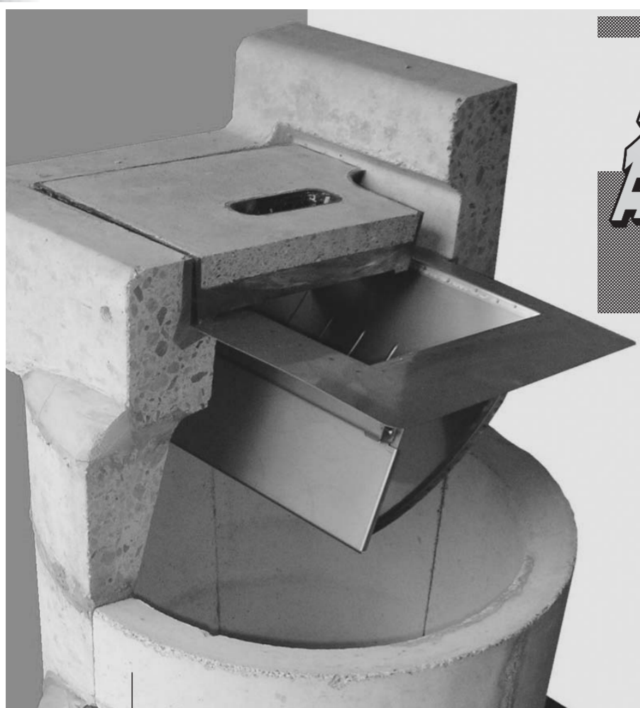
【写真上】雨水ますの蓋直下にセットする「ます用」。軽量で中蓋式のため取り付けが簡単で、よくあるます縁塊ブロックのズレにも対応できる。清掃・点検も容易に行える。
